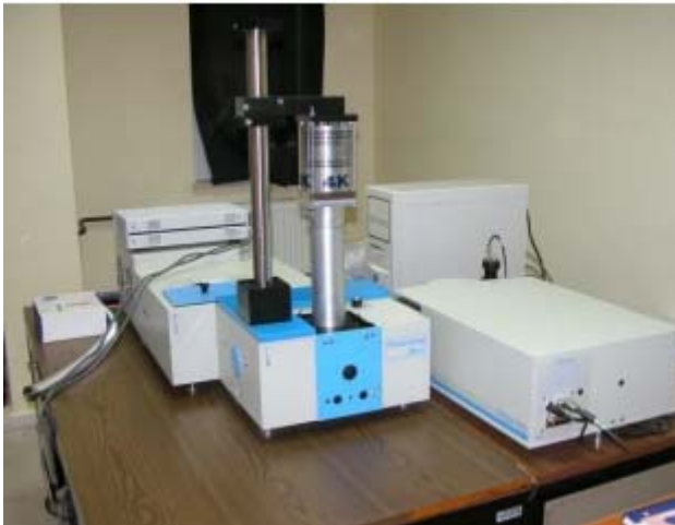
图示为安装在 Jobyn Yvon 光谱仪上的 CS202SE-DMX1-AL 系统 特别感谢：加齐大学 Suleyman 教授
