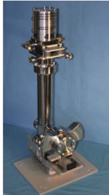
应用于 SOPRA 椭圆偏振计的超低振动系统
