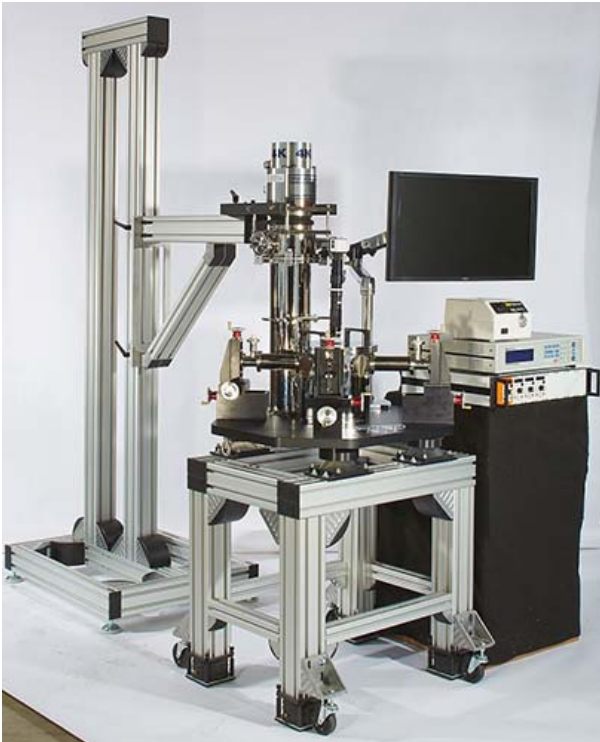
PS-CC 带定制压电式 XY 方向定位的显微光致发光无液氮低温探针台
